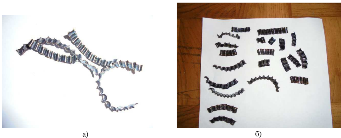
Рис. 6. Примеры стружек, полученных при обработке галтели (а) и цилиндрического участка (б) поверхности катания колеса грузового железнодорожного вагона
