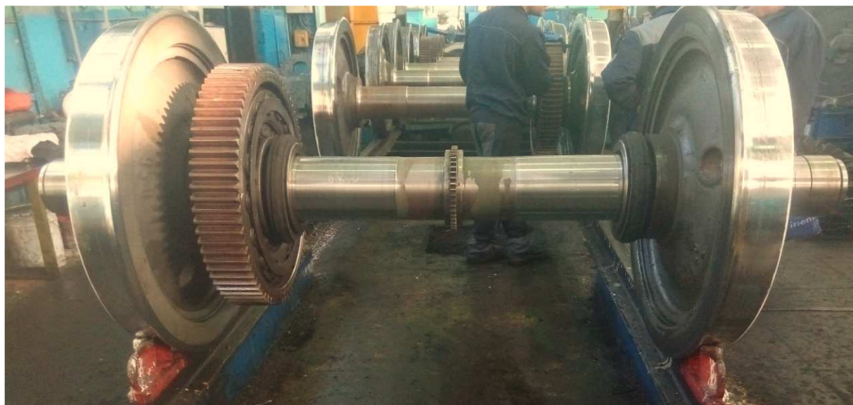
Рис. 2. Колёсная пара локомотива с восстановленной поверхностью
